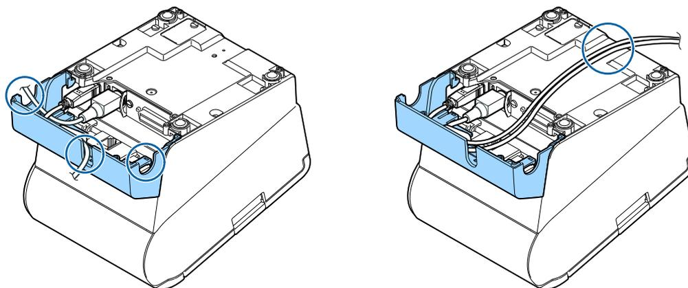
USB ケーブルをコネクタカバー背面のケーブル出口に通す場合は、抜け落ちるのを防ぐため、コネクタ部に力が加わらないよう引き回しを行った上で、プリンター本体のフックにUSBケーブルを引っ掛けます。
