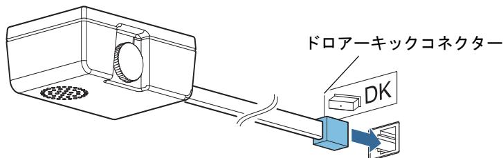
**5** 固定用テープの反対側のシールをはがし、外付けオプションブザーをプリンターケースに取り付けて固定します。
