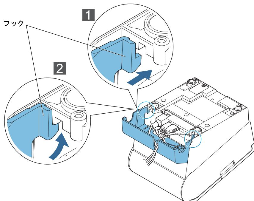
**4** ケーブルをケーブル出口に通します。ケーブルの本数が多い場合は、複数のケーブル出口を使用してください。
