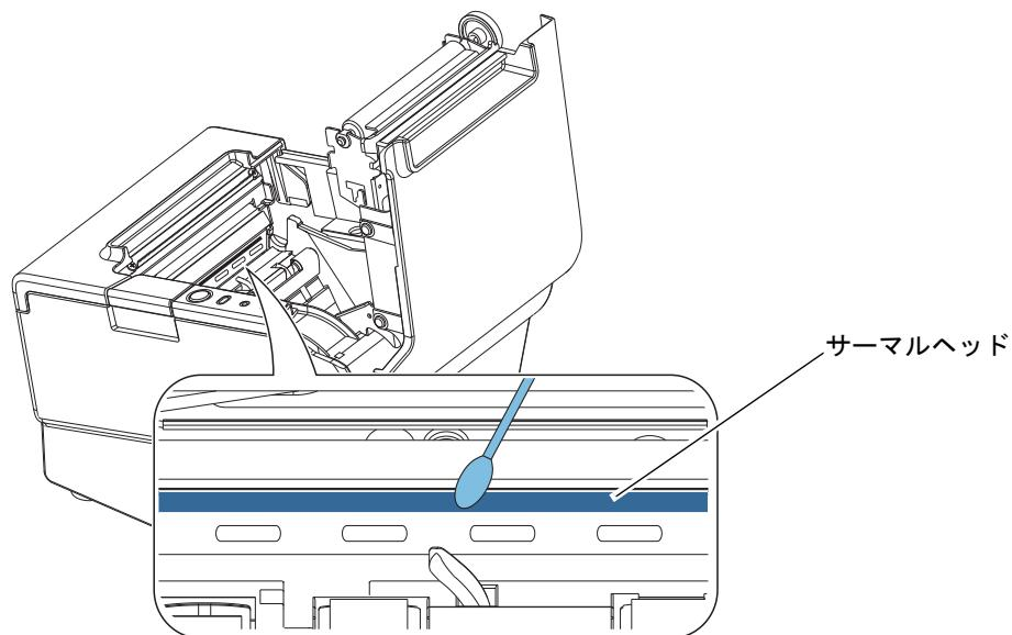
使用するロール紙によっては、紙粉がプラテンローラーやロール紙エンド検出器に付着することがあります。その場合は、軽く水を含ませた綿棒を使用して、プラテンローラーやロール紙エンド検出器に付着した紙粉を除去してください。完全に乾いてから、電源を入れてください。
