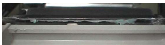
粘着物がカッター刃に付着している状態
