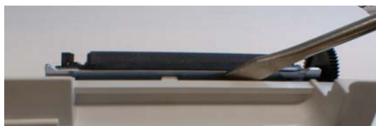
マイナスドライバーで粘着物を除去している様子
