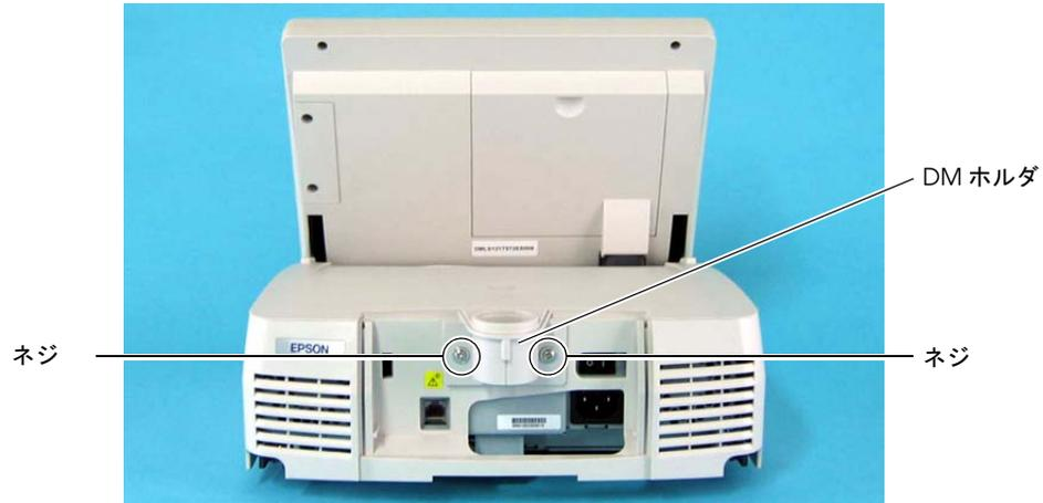
3. カスタマディスプレイの接続ケーブルを DM ホルダに通しながら、カスタマディスプレイ (または支柱) を DM ホルダに取り付けます。その際にカスタマディスプレイのタブが、DM ホルダに「カチッ」とはまるようにしてください。
