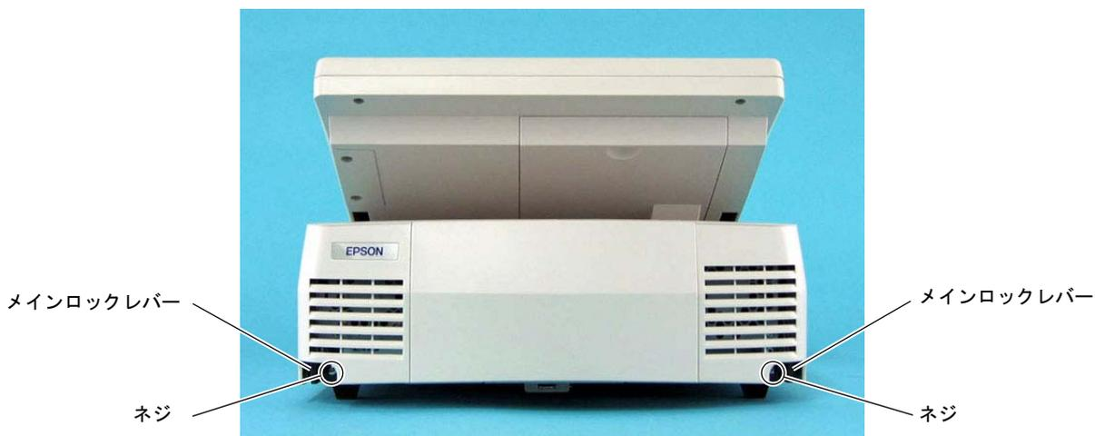
2. 上ケースブロックの左右にあるメインロックレバーを外側に押しながら (①)、矢印の方向に約 15mm スライドさせてフックを外し (②)、上に持ち上げて取り外します (③)。
