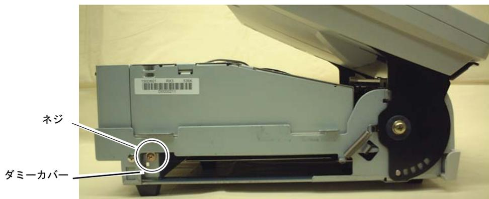
5. PCIカードを接続し、手順4で外したネジ1本でPCIカードを固定します。
