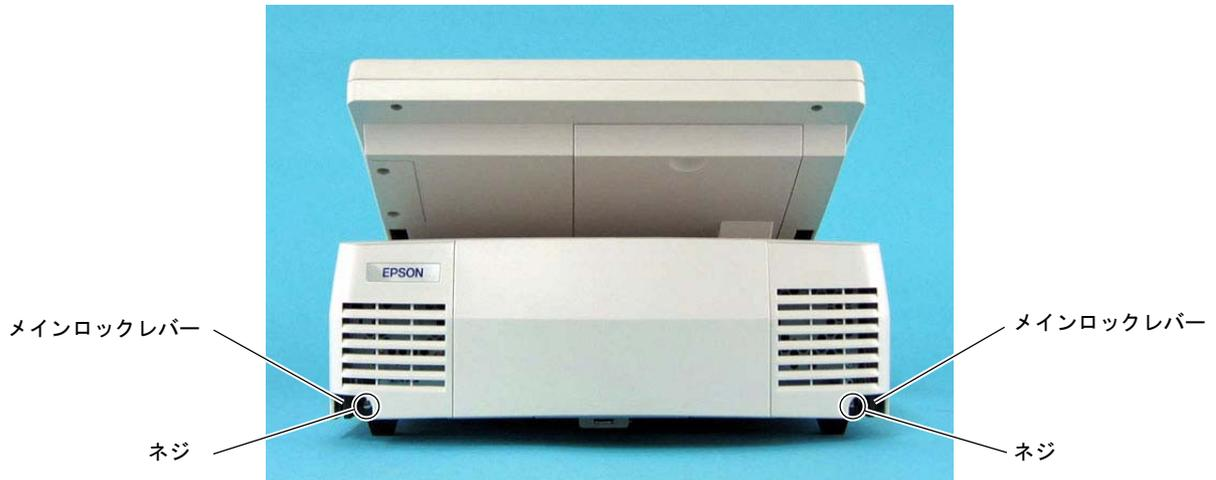
2. 上ケースブロックの左右にあるメインロックレバーを外側に押しながら (①)、矢印の方向に約 15mm スライドさせてフックを外し (②)、上に持ち上げて取り外します (③)。
