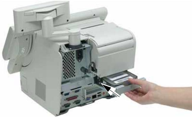
2. HDD ユニートをネジで固定します。
