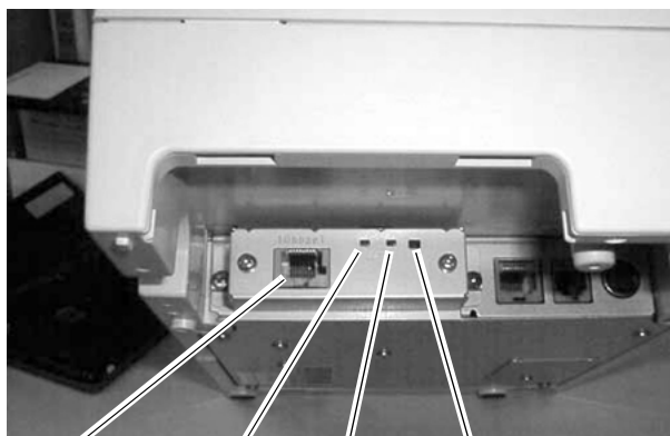
10BASE-T イーサネット インタフェースコネクタ LED (緑) LED (赤) スイッチ
